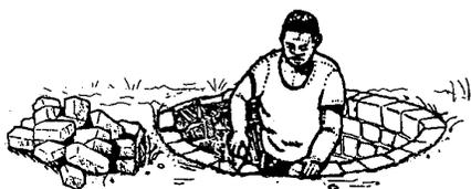
2. Cavar um buraco redondo para a fossa da latrina, como o da latrina fechada, mas um pouco maior, ou seja: com 1,5 m de diâmetro e 3 m de profundidade. Em cima da cova, fazer um círculo ao redor do buraco com tijolos de cimento, de modo a que estes estejam ao nível do chão. Depois da laje estar seca, coloca-se por cima da fossa.
